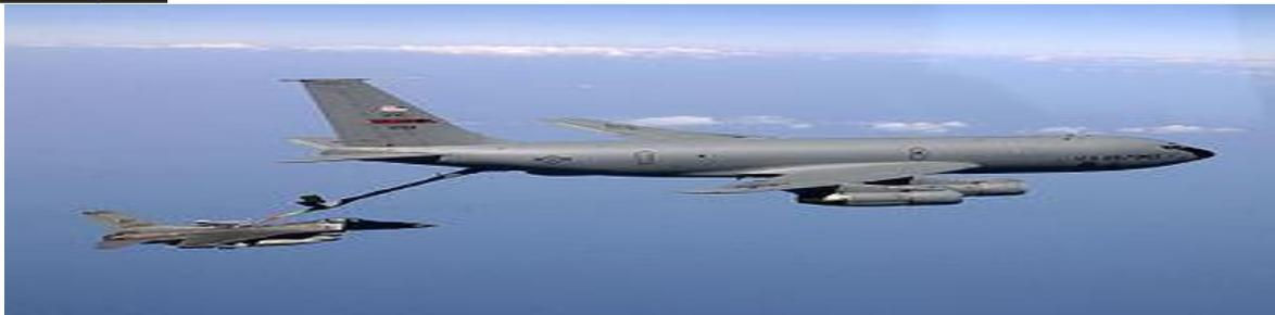
Lorsqu'il est ravitaillé en vol, un avion de chasse ne s'arrête pas (sinon, il tombe !). Et pourtant, il doit être fixe par rapport au ravitailleur.
